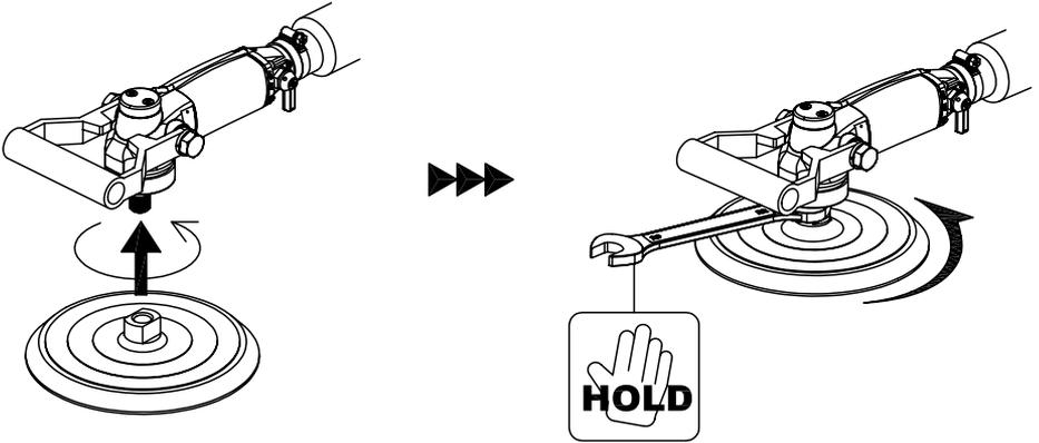
► **REMOVING THE ROTARY BACKER PAD**
