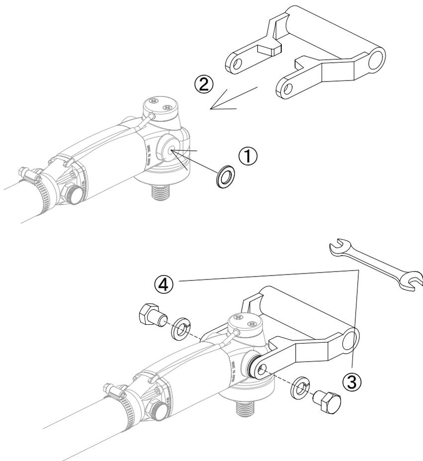
► **ATTACHING THE ROTARY BACKER PAD**
