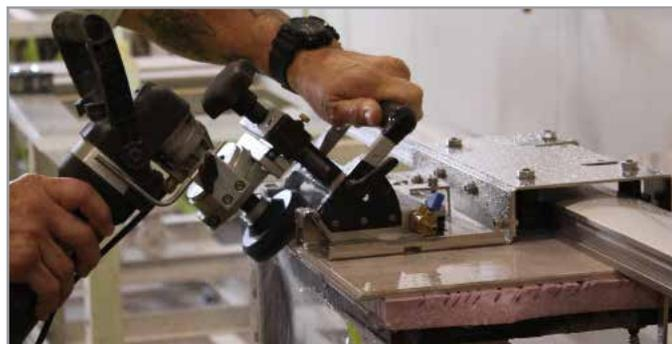
BEVELING AUXILIARY BASE & GUIDE RAIL SYSTEM
