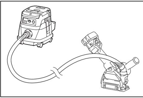
3. Ajuste el interruptor de modo en espera en la aspiradora en "AUTO".
