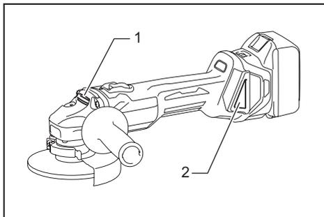
► 1. Ventilación de salida 2. Ventilación de entrada
